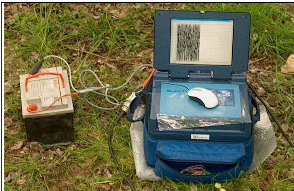
Foto 1 – Sismografo multicanale utilizzato durante l'esecuzione delle prove.
